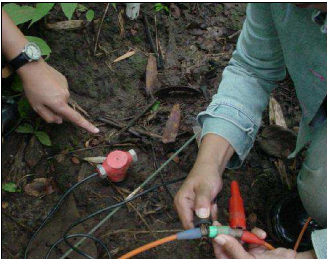
รูปที่ 3.6 แสดงการปักจีโอโฟน และการเชื่อมต่อสายนำสัญญาณ
