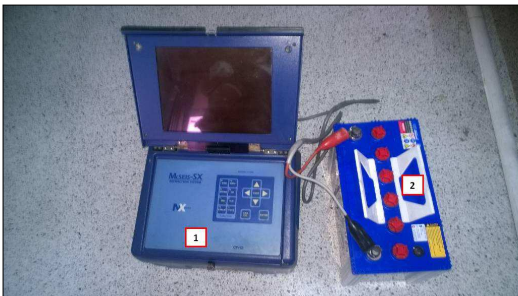
รูปที่ 3.3 แสดงชุดเครื่องมือบันทึกสัญญาณ และแบตเตอรี่
