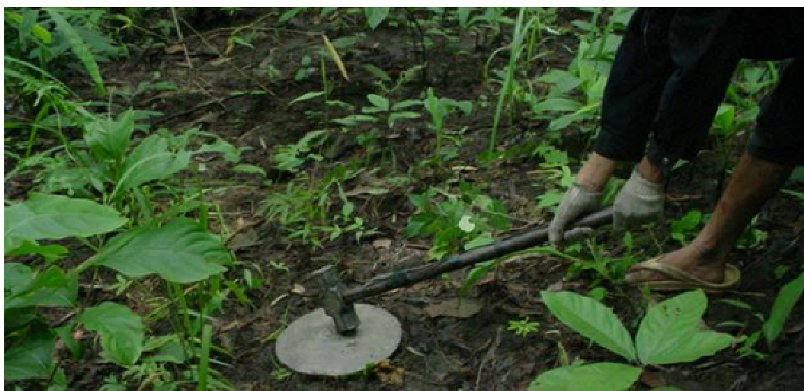
รูปที่ 3.1 แสดงการใช้ก้อนทุบแผ่นเหล็ก เพื่อเป็นแหล่งกำเนิดคลื่น
